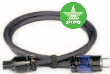
Кабель средней толщины и жесткости. Проводники изготовлены из монокристаллической меди, для внутреннего демпфирования применено хлопковое волокно. Разъемы Furutech — аппаратный разъем с посеребренными контактами, вилка с родиевым покрытием. Маркировки фазы нет. Звук быстрый, сухой и одновременно воздушный, подача скорее нейтральная. Динамика и детальность высокие. Бас среднего масштаба, очень быстрый
