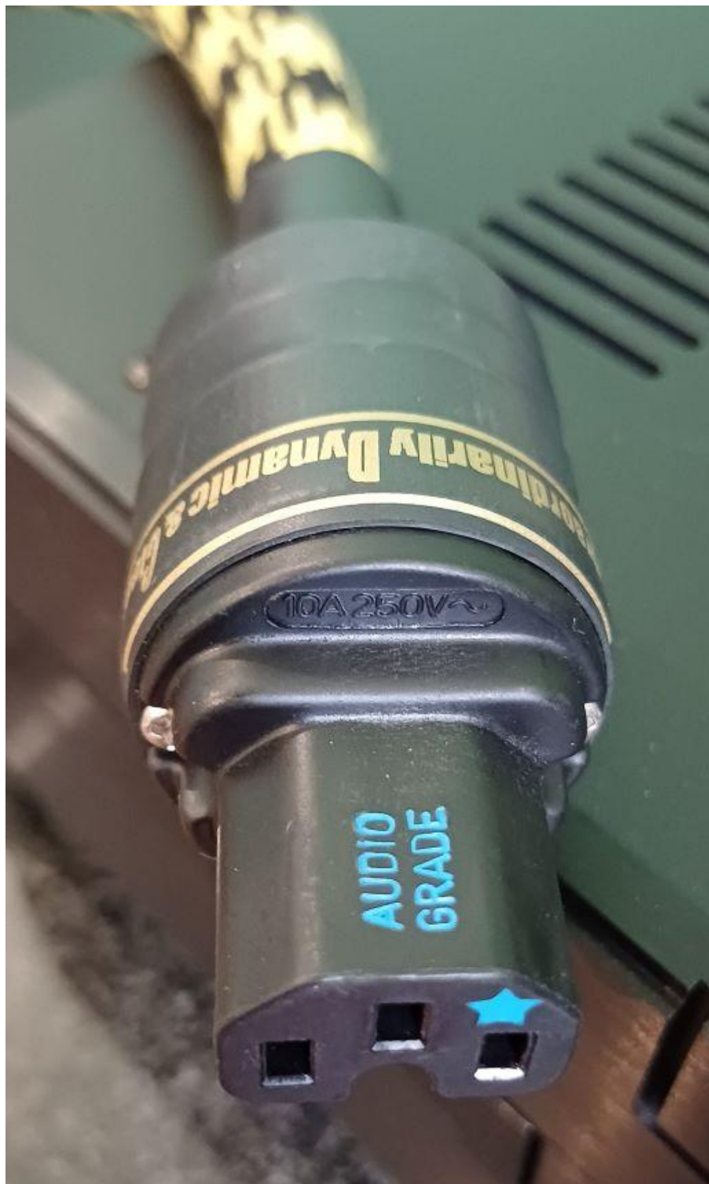
Hijiri SM2R-L "Sound Matter" – test. Oznaczono, gdzie powinna znajdować się faza (wstereo.pl)
