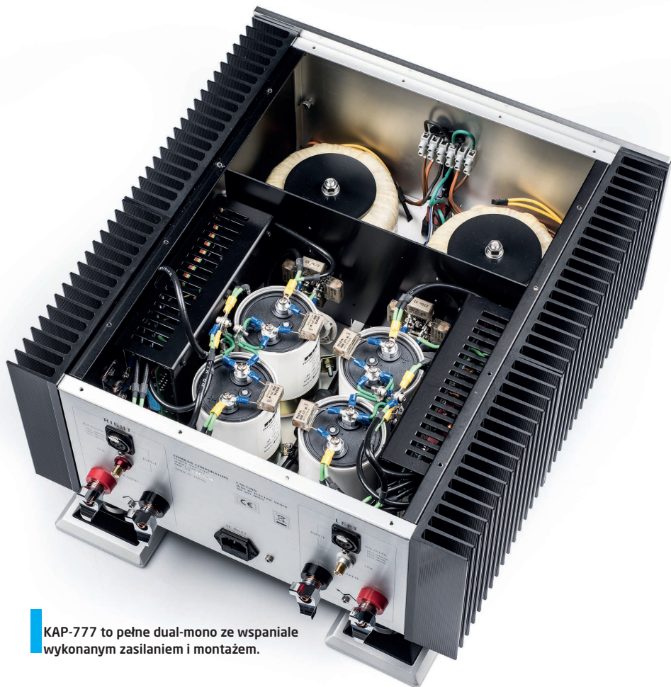
400 W na kanał (przy 4 \Omega ) z jednej pary tranzystorów końcowych jest możliwe - tyle że nie takich, które spotykamy w typowych aplikacjach audio.
