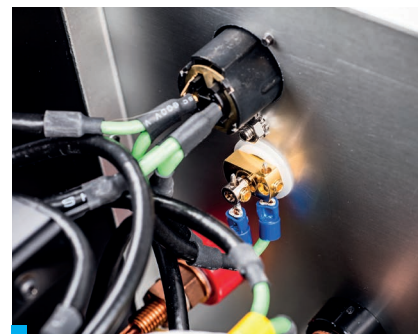
Staranność montażu widać także na przykładzie połączeń gniazd - coś niespotykanego. Miedziane terminale pochodzą od Mundorfa.
