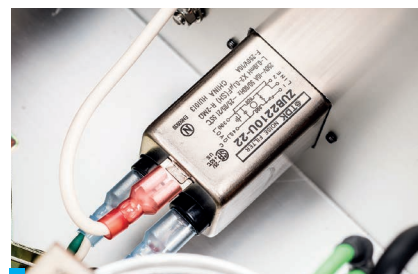
Zakłócenia z sieci energetycznej są tłumione na wejściu.
